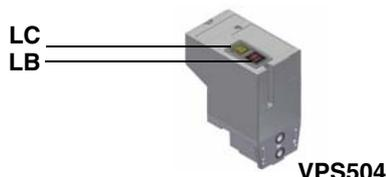
**Н.В.:** В случае горелок, оснащенных блоком контроля герметичности Dungs VPS504, фаза предварительной вентиляции начинается только после завершения контроля герметичности газовых клапанов с положительным результатом.
